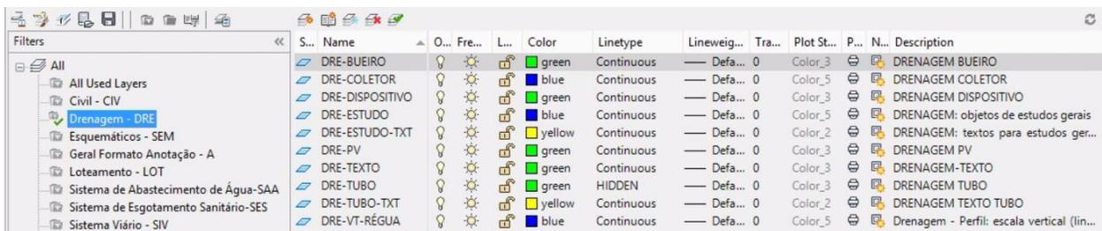
Template **\_AutoCAD Civil 3D 2019\_BRA (SANEAMENTO).DWT** – Filtro: Esquemáticos – SEM
