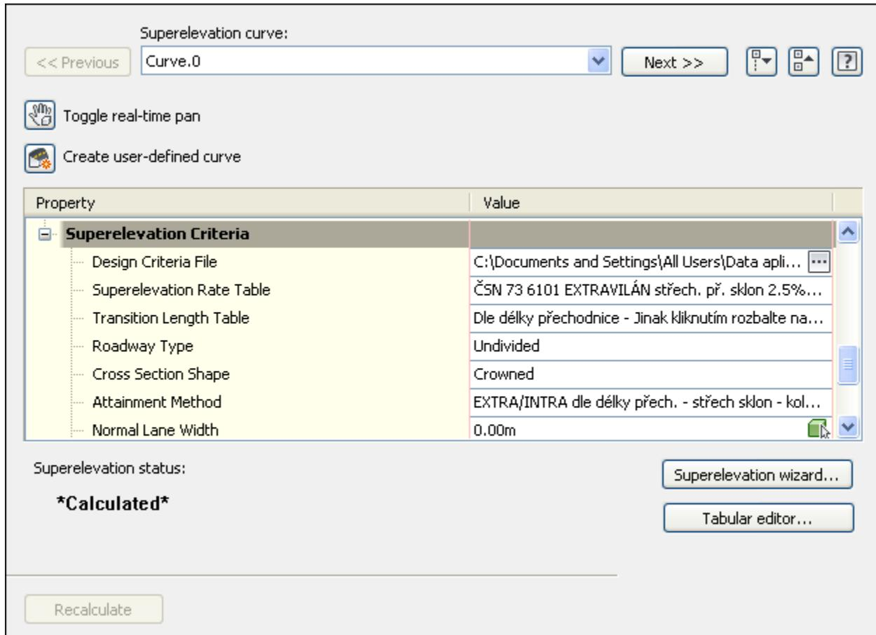
Vyberte položku „Soubor kriterí návrhu (Design Criteria File). Pomocí vyberte „CZ\_Klopeni\_rozsireni\_AutoCAD\_Civil\_3D“
