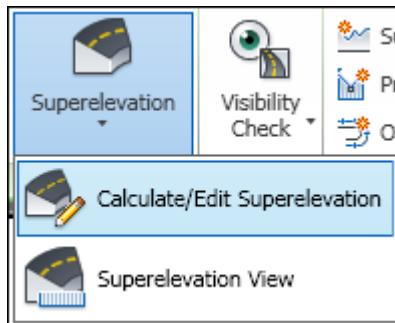
Parametry můžete nastavit pro každý oblouk trasy zvlášť (viz Obr. Níže), nebo použít „Průvodce klopení (Superelevation wizard)“, který umožňuje výpočet pro celou trasu najednou.
